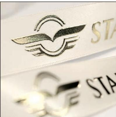
Auf das Band wird im ersten Arbeitsschritt ein spezieller Kleber aufgebracht, der anschließend mit einer Folie flach oder erhaben „versiegelt“ wird.
